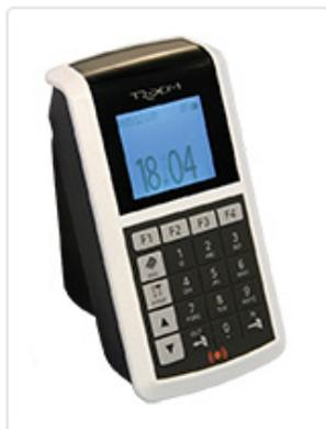
**G** EO è un terminale destinato alla **Rilevazione Presenze**, ma non solo. E' stato progettato per fare **Controllo Accessi, Info Point, Domotica, Prenotazione Mensa, Controllo Ronda, e per tutte le applicazioni di raccolta dati di campo indoor ed outdoor.**
